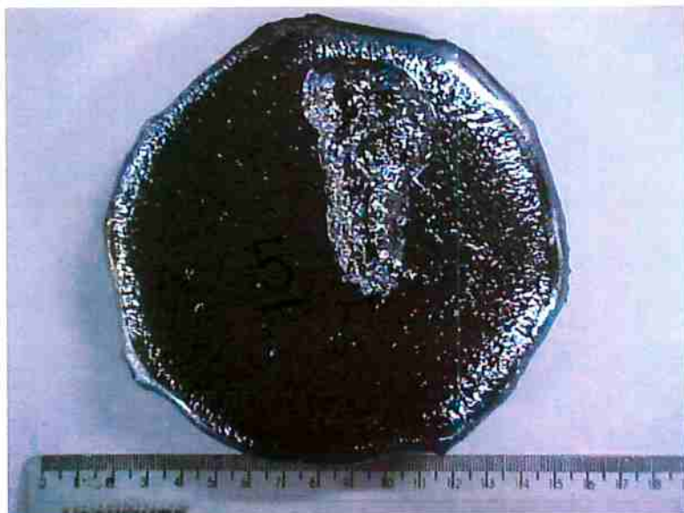
Figura 41: Aspecto de lingote se solidificação controlada.
