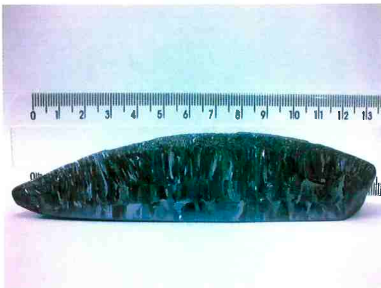
Figura 44: Macrografia do botão sem controle de solidificação.
